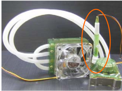
SilentStream ® Original: Feststehendes Rohr mit LED Anzeige SilentStream ® Verbesserung: Langer flexibler Schlauch
